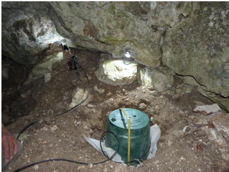
Figure 5: Installation de l'éco-compteur avant dissimulation
