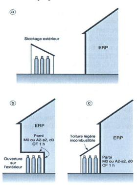
Les bouteilles stockées en extérieur devront être placées hors des zones accessibles au public. Le sol du local ou de l'emplacement du stockage devra être horizontal et réalisé en matériaux classés en catégorie M0 ou A2fl-s1.
