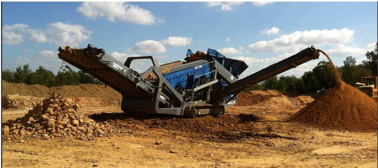
Illustration 2 : Exemple de crible mobile qui sera mis en place (ici : modèle Kleeman R155)
