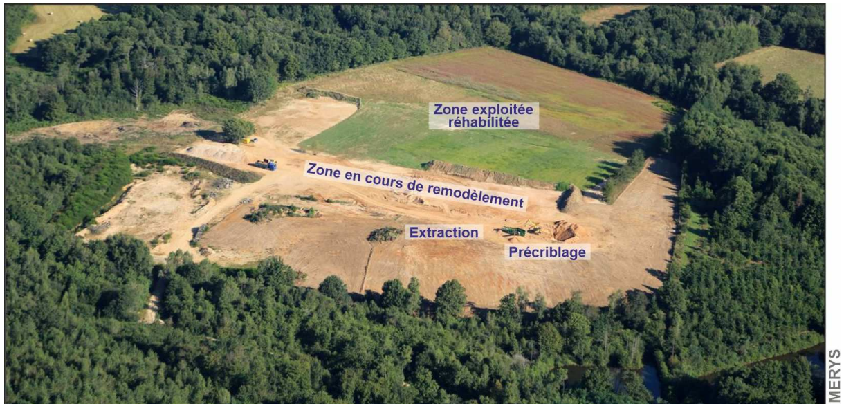
Figure 5 : Principe d'exploitation (vue de chantiers similaires – Imerys site de St-Paul-la-Roche)
